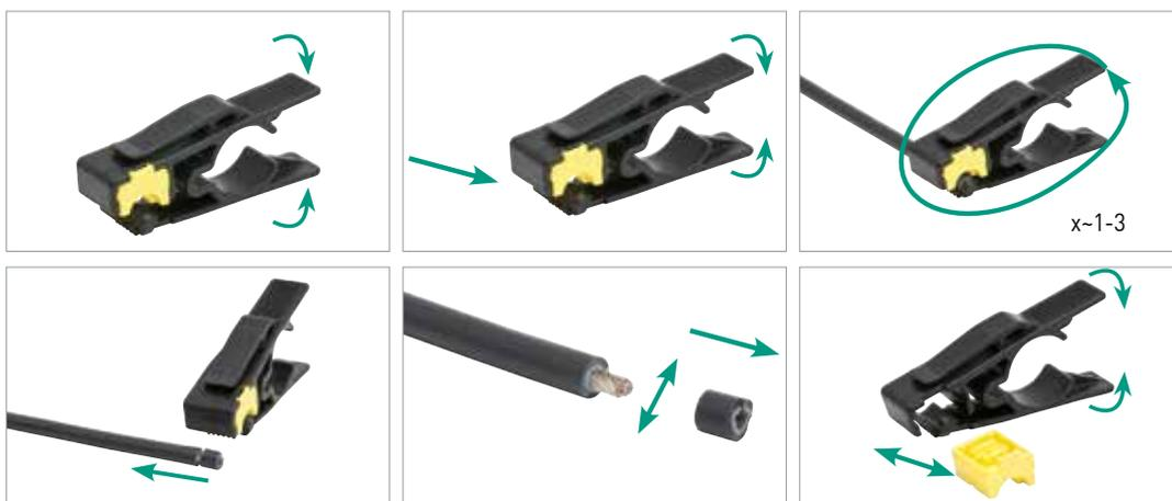
Questa spellacavi è in grado di spelare cavi aventi sezioni di 2,5, 4, 6 e 10 mm<sup>2</sup>. Provvista di un riscontro a battuta, consente una lunghezza di spelatura fissa e costante di circa 8 mm conforme a quanto richiesto dai nostri PIN. La lama è intercambiabile.
