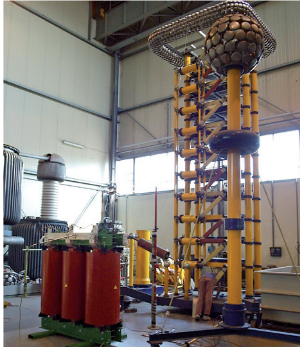
Prova impulso atmosferico al CESI (MI)
