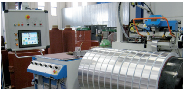
Avvolgimento di alta tensione in alluminio
