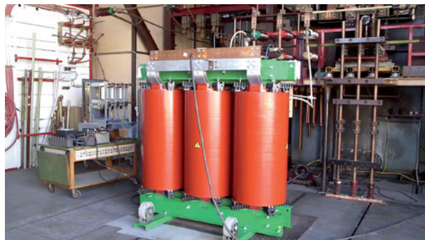
Prova di cortocircuito al CESI (MI)
