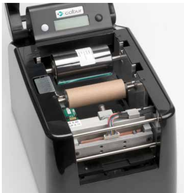
Inserimento del nastro sul supporto posteriore
