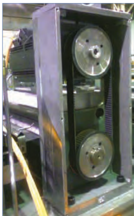
Alimentatore per presse con un servomotore convenzionale, riduttore, cinghia e pulegge.
