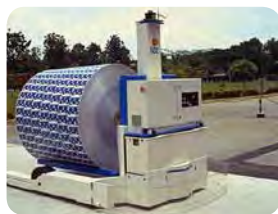
Primo veicolo con guida laser al mondo Tetra Pak, Singapore, 1990
