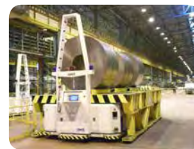
Primo veicolo AGV al mondo con 16 ruote controllate Posco Steel, Corea del Sud, 2009
